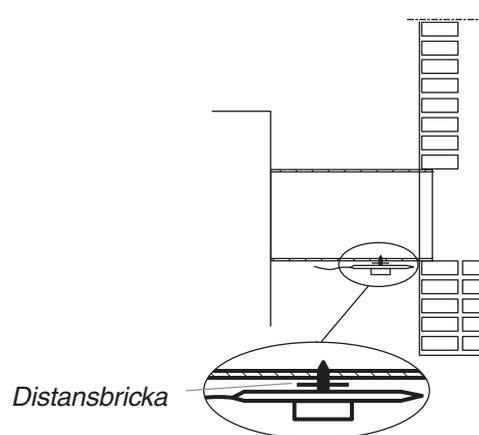
På pannor med låga rökgastemperaturer monteras den på sidan eller överdelen av rökröret utan distansbricka.
