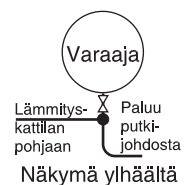
Kuva 6 Oikea putkijohtoliitos varaajaan
